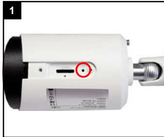
Für Reset: Fünf Sekunden lang die Taste gedrückt halten.
